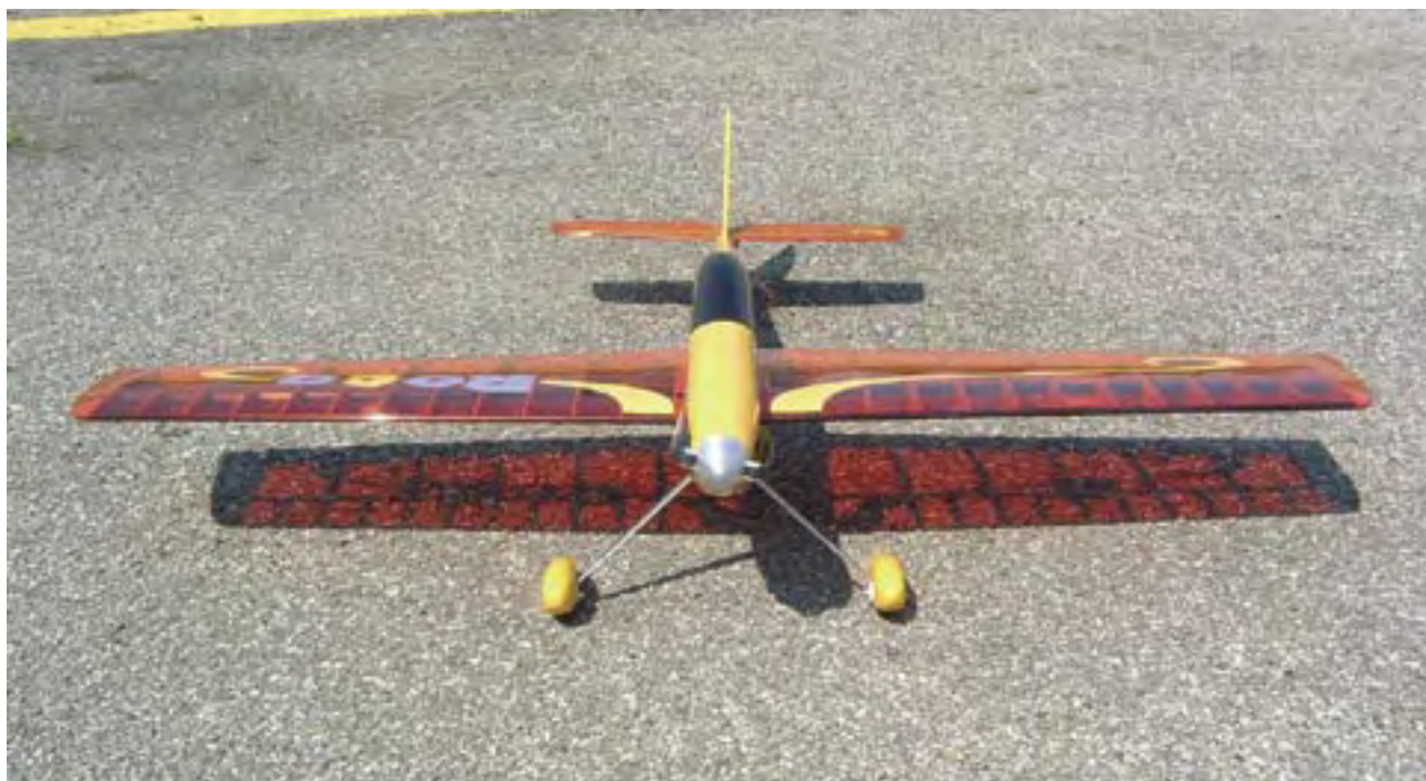
Vista frontale con le pale dell'elica ripiegate contro la fusoliera
